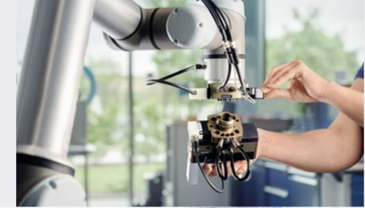
Werkzeugwechsler & Optionsmodule
