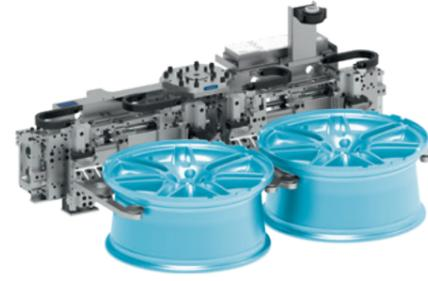
Doppelgreifeinheit zum Umsetzen von Felgen
