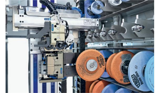
Automatischer Wechsel von Schleifscheiben
